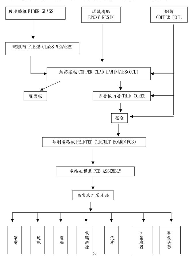
電子資訊系統等產業帶動全球資訊化時代的來臨及熱潮,而印刷電路板是各種消費性電子、電腦、通訊、資訊電子、工業用控制及醫療儀器設備的基礎零件,同時也是在提昇這些電子產業技術中涉及電子構裝高積化、高速化的主要環節,在印刷電路板工業持續成長下,銅箔業者亦不斷地朝多層化之電解銅箔發展,其主要用途為供應銅箔基板製造商生產銅箔基板以供應印刷電路板廠,及以壓合於多層板之外層之印刷電路板廠。
